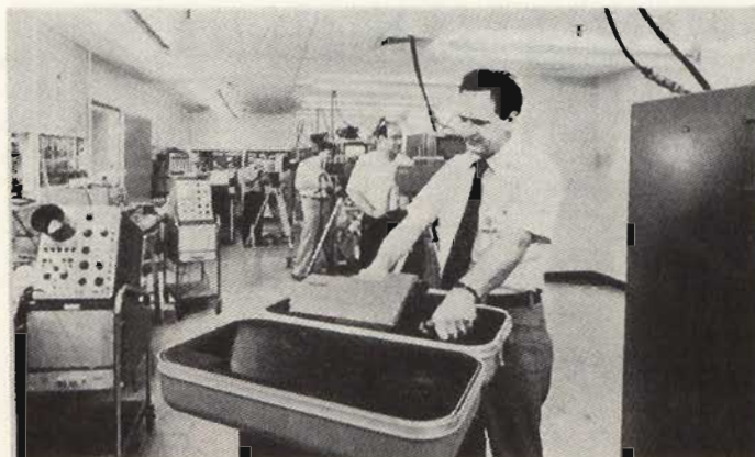
Fig. 15 - Una delle cinque telecamere per ENG TK-76 dell'RCA che verranno impiegate durante le olimpiadi. Nella foto un tecnico mentre imballa una TK-76 dopo il controllo di qualità.
