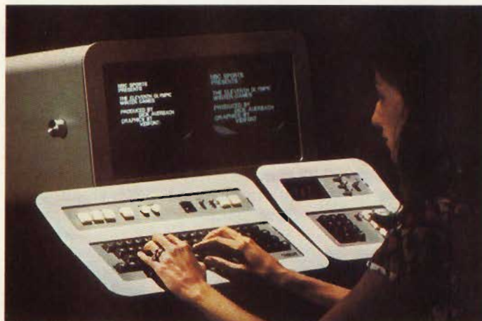
Fig. 16 - Il generatore elettronico di caratteri TV della Thomson-CSF, scelto dai sovietici per le Olimpiadi di Mosca. Una serie di questi apparati verranno installati presso il nuovo centro Radio-TV di Ostankino. (FOTO Thomson-CSF).
