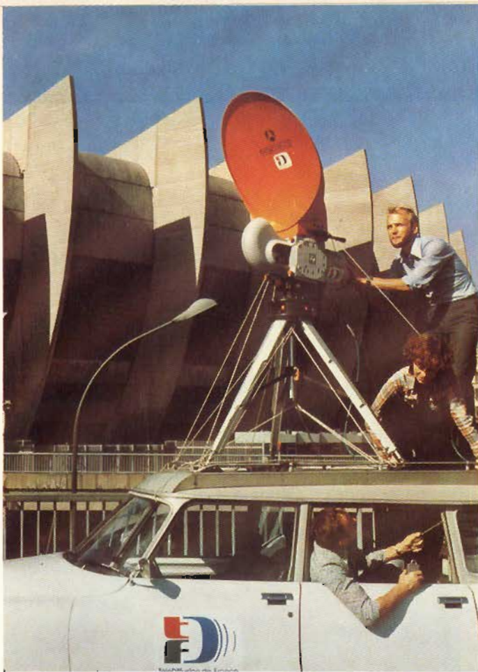
Fig. 13 - Uno dei 40 relé a microonde mod. TM 3T3 per le riprese mobili. (FOTO Thomson-CSF).
